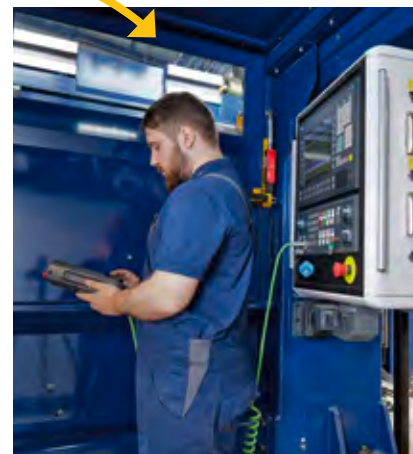
Heutzutage verrichtet eine Unterflurdrehbank diese Arbeit, wobei selbstverständlich digitale Technik zum Einsatz kommt
